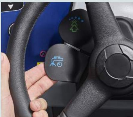
Levier SmartFlow™ intermittent intégré au volant : réduit le débit d'eau sur le plateau, évite les projections dans les virages, diminue la consommation et garantit une performance de séchage optimale
