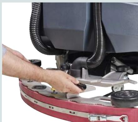
L'embouchure est conçue pour être facilement retirée de son support à l'aide des poignées ergonomiques puisque aucune connexion/déconnexion n'est nécessaire
